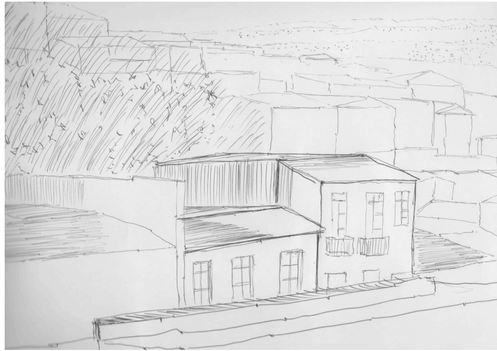
Desde el exterior se aprecia las ventanas de madera con palillaje intermedio de trama regular, vidrios transparentes. rejas metálicas para los balcones trabajados para la época.
